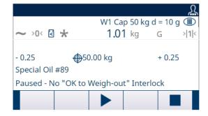
Abb. 21: Kein diskreter Eingang Sperren
