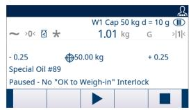
Abb. 68: Diskreter Eingang keine Verriegelungen
