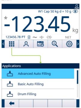
Abb. 1: Rufen Sie die Anwendung über AppEntry (Anwendungszugriff) auf.
