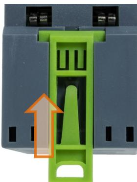
Para quitar el ACT350, sencillamente coloque la hoja de un destornillador en el pestillo y presione hacia abajo.
